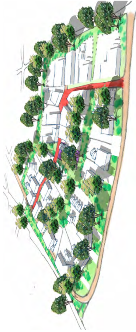
Simulation de zone d'activités : regroupement du stationnement, large place prévue pour les espaces verts, toitures des bâtiments homogènes (toits terrassés), voirie traversante, espaces piétonniers...
